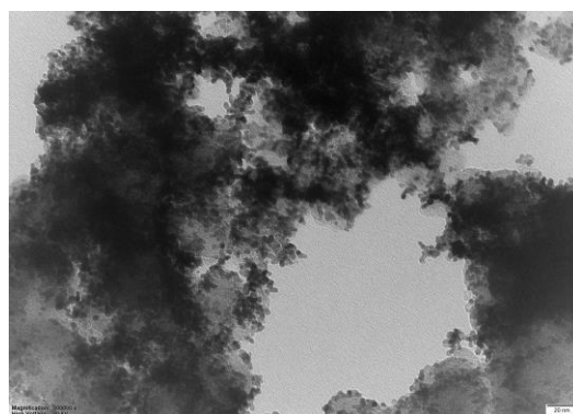
Figura 2 – Microscopia eletrônica de transmissão obtida para o catalisador \text{Pt}_2\text{Rh}_2/\text{SnO}_2/\text{C} .
