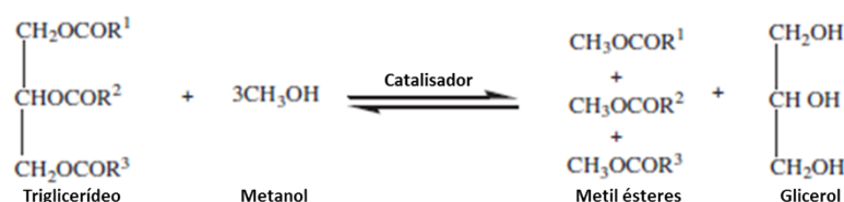
Figura 1 - Reação de Transesterificação do triglicerídeo com metanol em presença de catalisador. (Traduzido e adaptado de Tariq et al., 2012)
