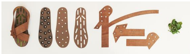
Figura 1: Despiece de sandalias hechas por corte laser. Anastasiya Mass
