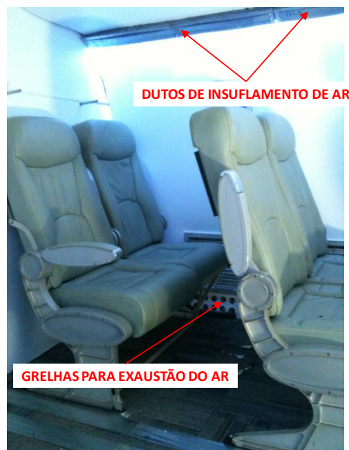
Figura 6 – Interior do mock-up , configurado para a arquitetura de ventilação por mistura, MV
