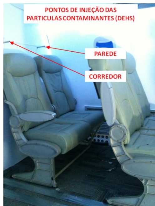
Figura 9 – Pontos de injeção das partículas contaminantes
