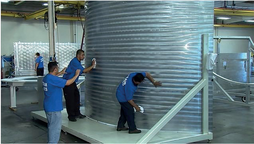
Figura 2: casca externa de foguete em montagem
