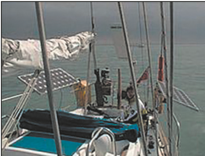
Figura 2.11 Exemplo de pequena instalação contando com dois painéis
