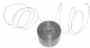
**Figura 4.21** – Fotografia da matriz de extrusão montada com o aquecedor
