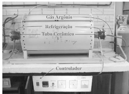
**Figura 3.8** – Forno de sinterização fabricado no LdTM/UFRGS.
