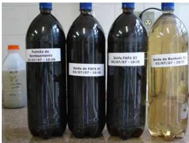
Figura 5.17 Quatro amostras de lixiviado analisadas no Laboratório de Saneamento da EESC, em julho de 2007.
