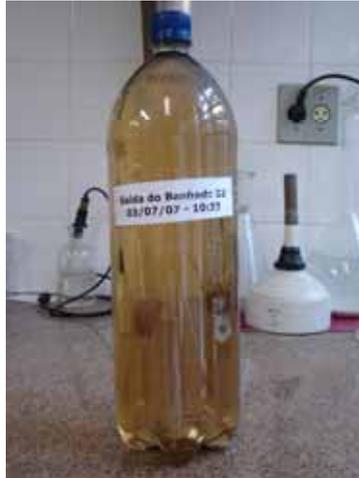
Figura 5.18 Amostra de lixiviado coletada na saída do banhado de fluxo subsuperficial.
