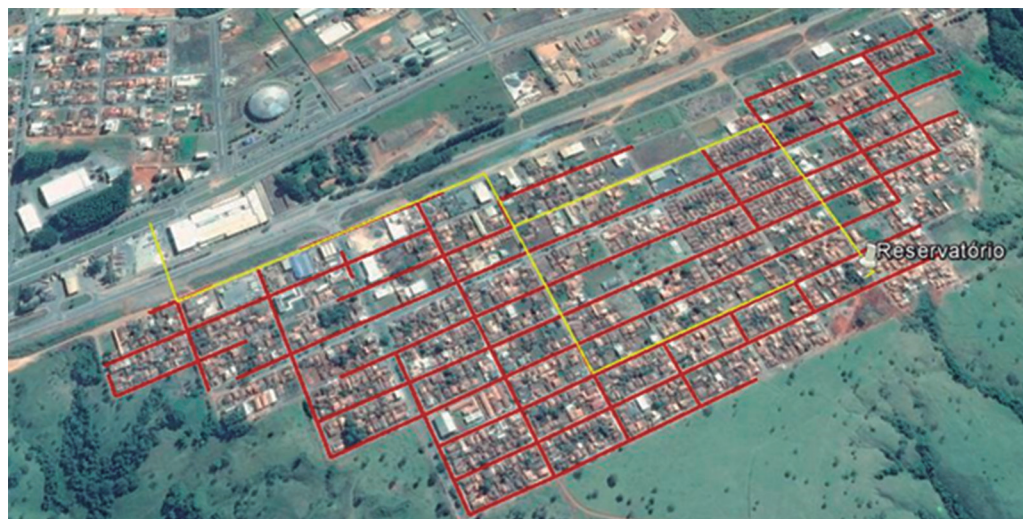
Figura 2. Traçado da rede de abastecimento. Fonte: adaptada de Google Earth (2015).
