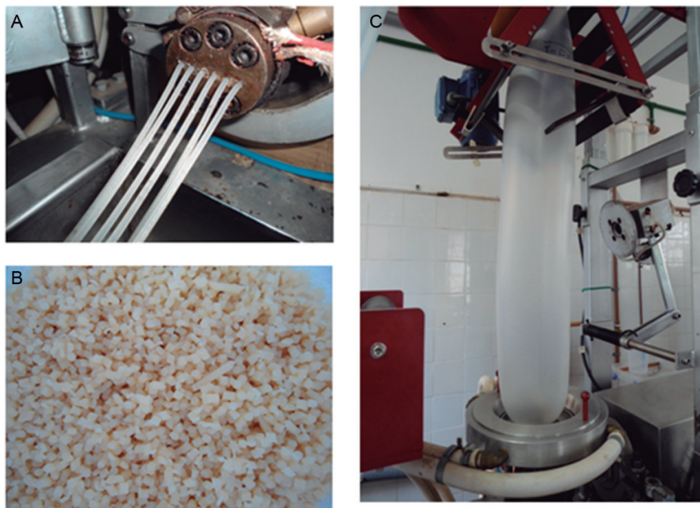
Figura 13.5 Etapas do processo de elaboração dos filmes. A: peletes; B: peletes triturados; C: balão formado durante o processo de extrusão-sopro
