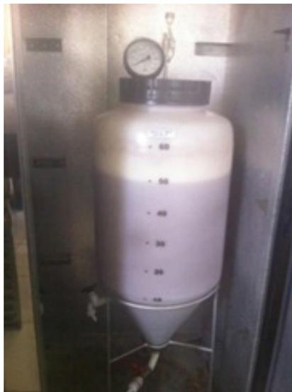
**Figura 1.5** Fotografia do tanque de fermentação armazenado em refrigeração
