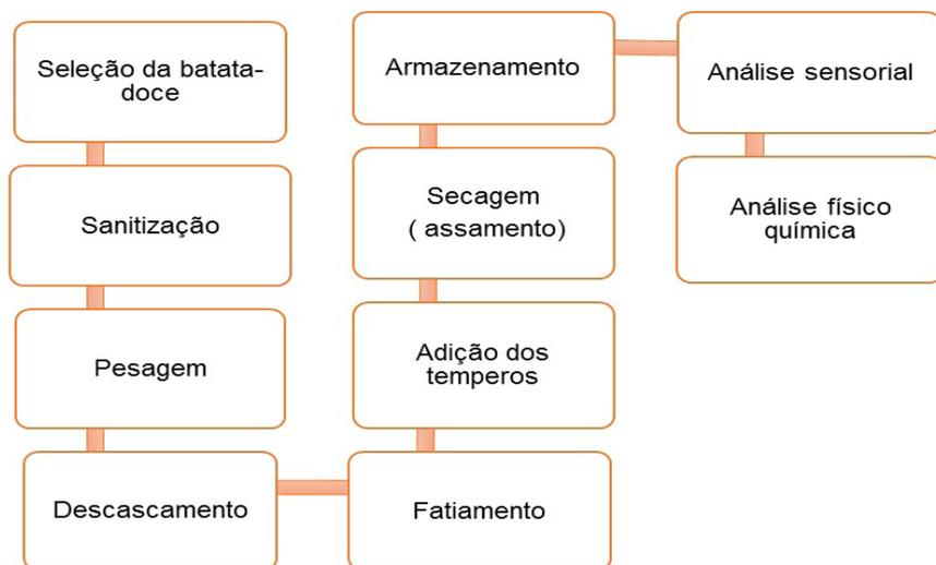
Figura 10.1 Esquema de processamento do *snack* de batata-doce
