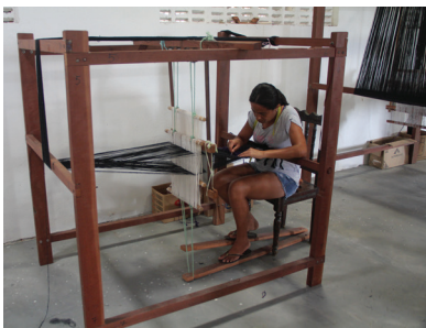
Um dos cinco teares de dois pedais existentes na associação. Antigos, dificultam a produção de peças com qualidade de acabamento. Fonte: IPTI - Chico Bicalho.
