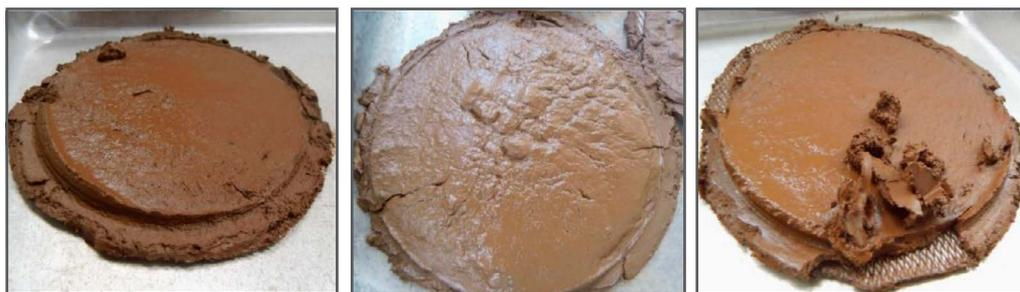
Figura 4 – Pastas minerais produzidas a partir do rejeito de rocha fosfática.
