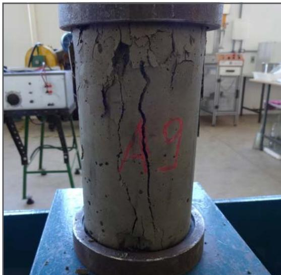
Figura 3 – Corpo de prova após ruptura em prensa hidráulica
