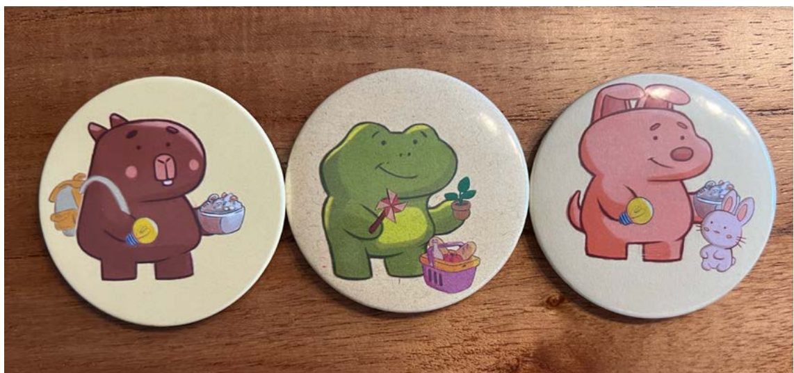
Figura 17: Bottons produzidos em caráter experimental. O primeiro, à esquerda, emprega matriz plana e papel couchê (opção selecionada), enquanto os dois últimos empregam matriz convexa e papel reciclado e sulfite, respectivamente.
