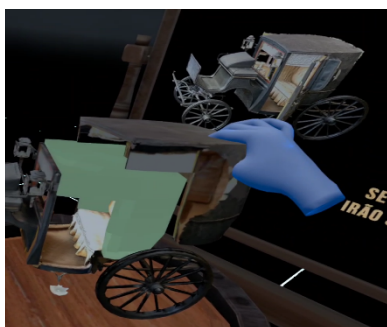
Figura 10 e 11 – Molde visual (em verde à esquerda), e uso de partículas (destacadas em círculo vermelho) de posição para indicar que a peça está na posição correta. Fonte: (o autor).
