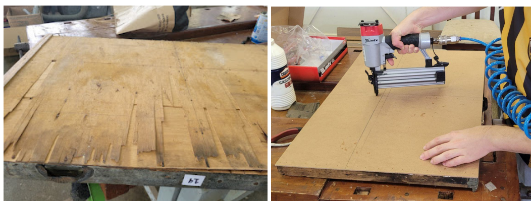
Figura 3: Processo de substituição do fundo da gaveta.
