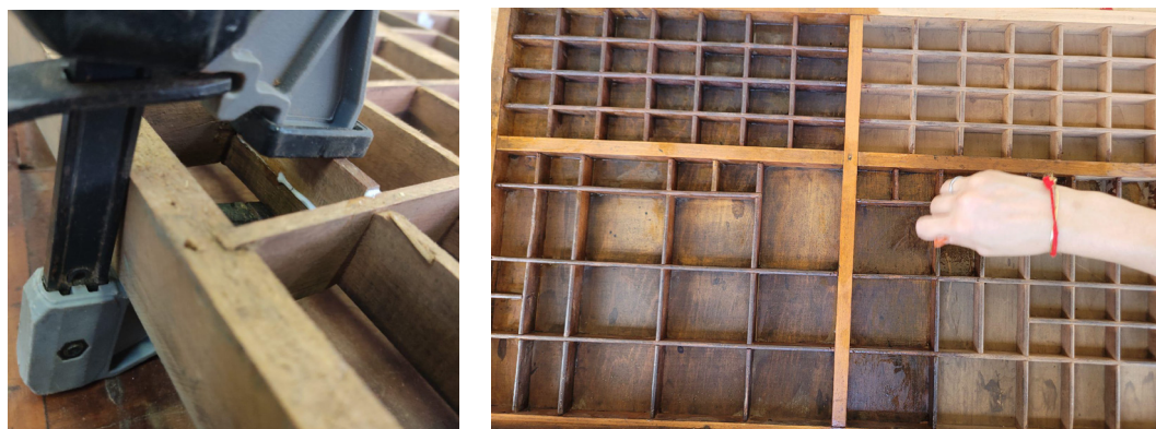
Figura 4: Cola das divisórias e aplicação de verniz.
