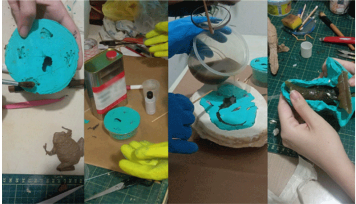
Figura 11: Formas em silicone e fundição de originais em resina
