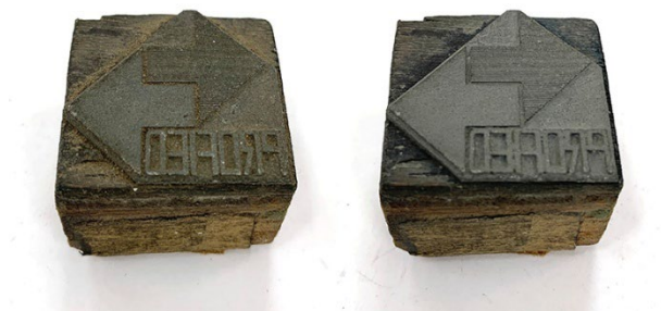
Figura 4: Clichê Profied antes e depois da limpeza.
