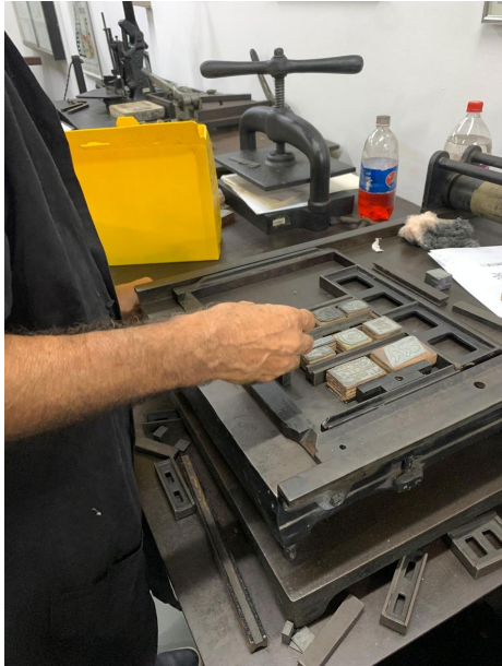
Figura 5: Montagem dos clichês na rama tipográfica.
