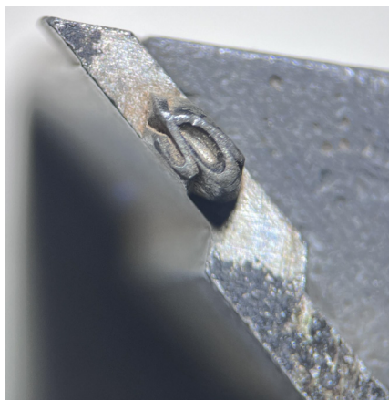
Figura 5: Imagem captada com lupa evidenciando o formato inclinado do tipo.
