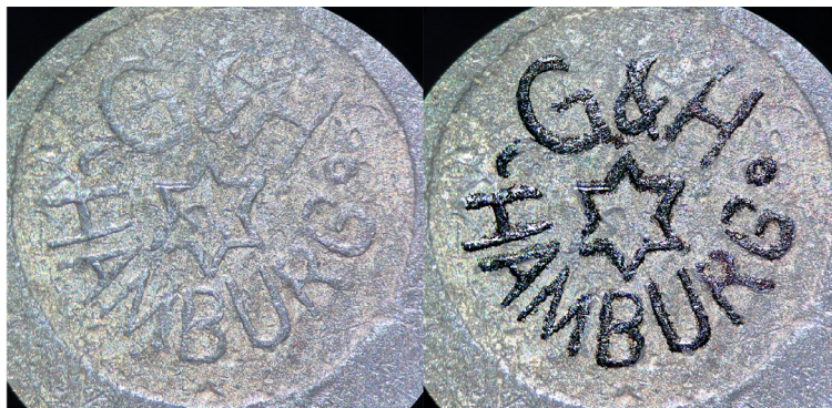
Figura 6: Marca da fundidora encontrada nos tipos da gaveta 4.
