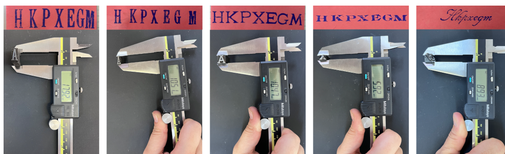
Figura 3: Tipos medidos com paquímetro digital.
