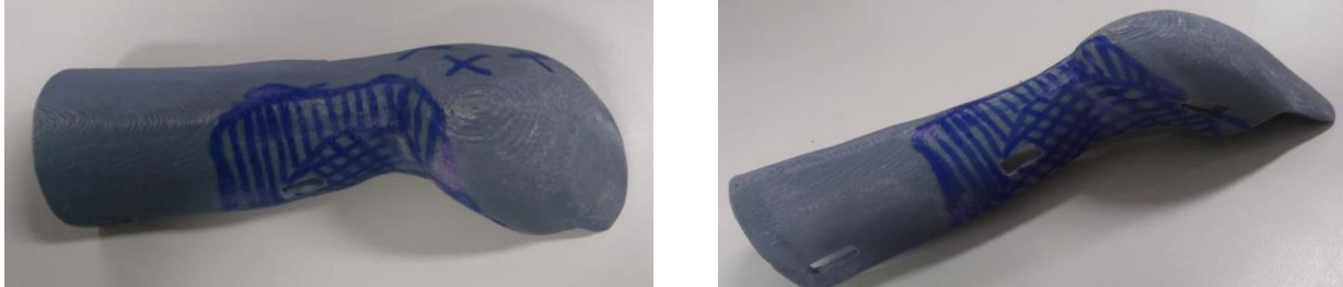
Figura 7: Marcação das regiões de forte tensão na órtese
