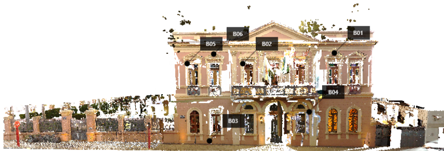
Figura 4. Nuvem de pontos gerada por meio do levantamento com laser scanner da fachada do Palacete Bento Carlos. Fonte: Autores, 2022
