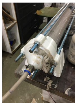
Figura 5, 6 e 7. Mostram as falhas que ocorreram devido às peças impressas não suportarem a pressão na terceira versão da máquina. Fonte: Autor, 2022
