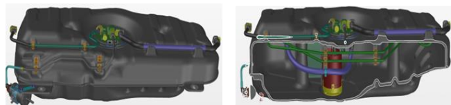
Figura 1- Modelamento matemático do Tanque Plástico Híbrido
