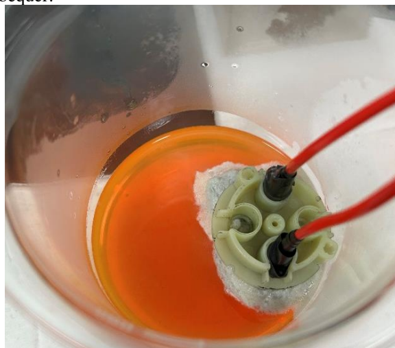
Figura 8 – Fluido Convencional OAT com evaporação e degradação
