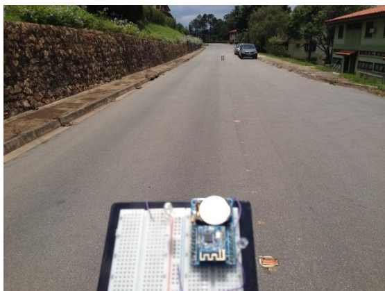
Figura 14 - Teste de comunicação ao ar livre - Grandes distâncias. Fonte: Autoria própria.
