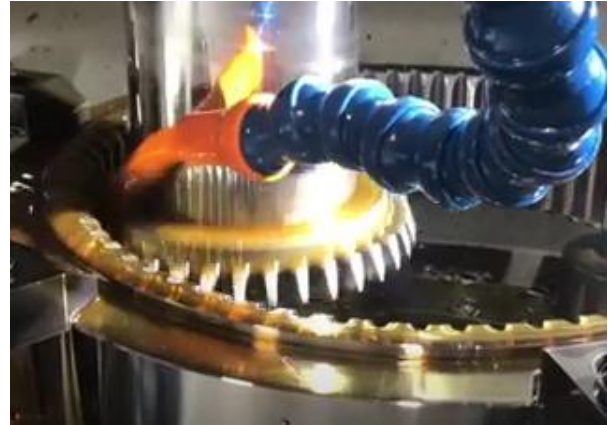
Figura 4: A ferramenta verdadeiramente possui lâminas no lugar dos dentes.
