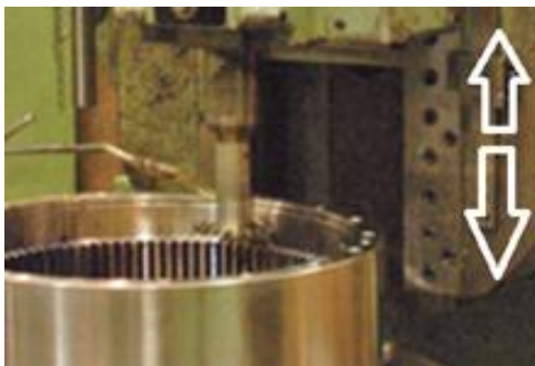
Figura 3: Aplainamento com ferramenta de corte no formato de uma engrenagem de dentes externos. O movimento da ferramenta é axial.
