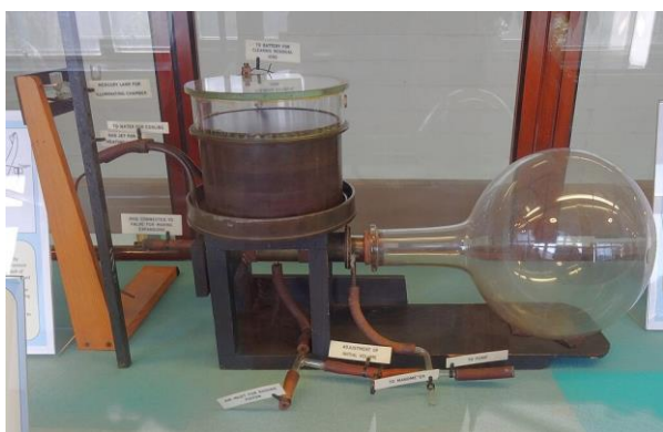
Figura 1: Câmara de nuvens criada por Charles Thomson Rees Wilson Fonte: Laboratório Cavendish
