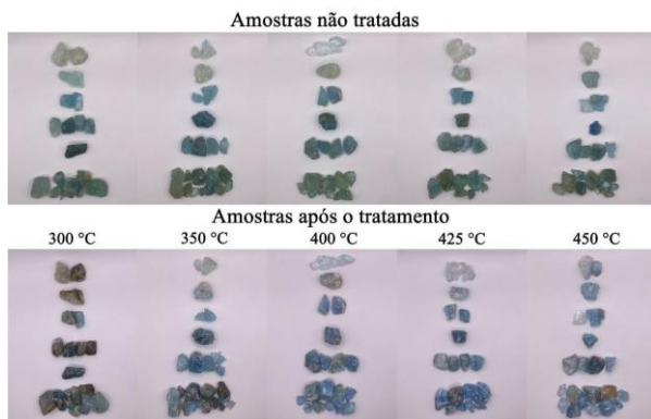
Figura 3: Fotografia das amostras brutas de água-marinha aquecidas na segunda fase da pesquisa. Fonte: Produção dos próprios autores.
